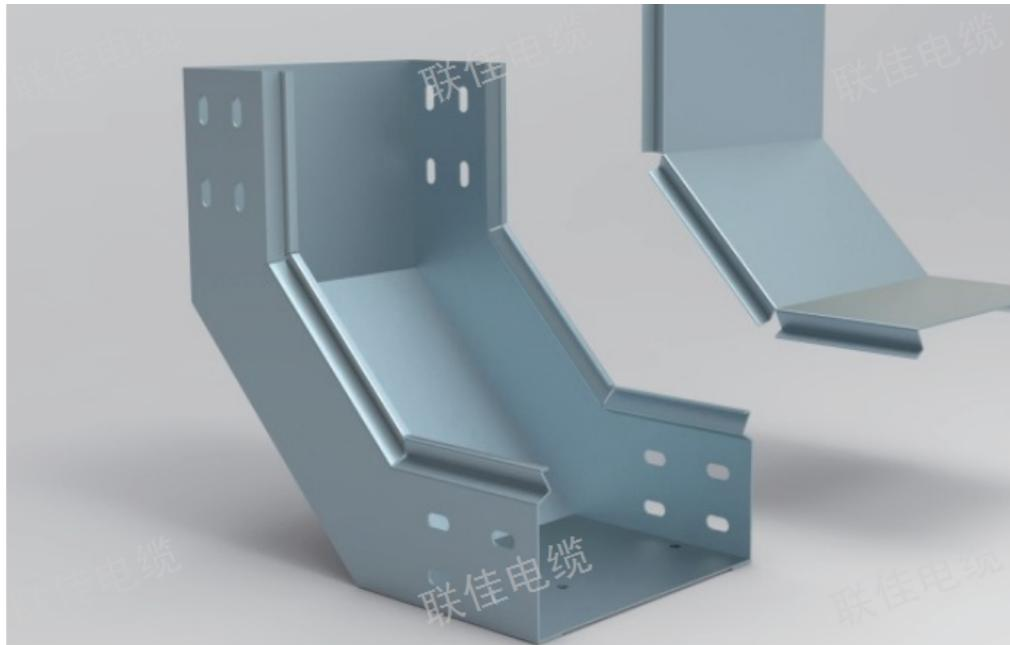
自锁式电缆桥架施工安装要点：自锁式电缆桥架及线槽敷设走向应短捷，并应尽量沿墙、沿柱或沿梁敷设。根据自锁式电缆桥架及线槽敷设走向，向土建专业、结构专业提出预留墙洞、楼板洞及吊架安装时，所需预埋钢板位置及荷载。并且应与工艺专业、水暖专业及动力专业相协调。地面内暗装金属线槽布线，在设计时应与土建专业密切配合，以便根据不同的结构型式和建筑布局，合理确定线路路径和设备选型。不同电压、不同用途的电缆不宜敷设在同一层自锁式电缆桥架内（1） $1kV$  以上和 $1kV$  及以下的电缆；（2）同一路径向一级负荷供电的双回路电缆；（3）应急照明和其他照明的电缆。
