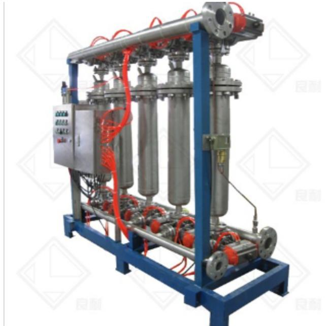
密闭板式过滤器主体是由滤槽、滤网片，起盖机构、自动排渣装置等组成。助滤剂在混合缸中与物料混合后，通过输泵在滤网片上形成饼层，一旦达到稳定的滤饼层后，细小的助滤料颗粒可提供无数的细微通道，困助悬浮的杂物，但也容许清澈的液体通过，不会有所堵塞，这样物料就通过滤饼层进行实际过滤。密闭板式过滤器滤网片是由多层不锈钢网组成，安装在中心集料管上，装拆清理十分方便。该产品设计结构独特，体积小，过滤效率高、滤液透明度和细度好，无物料消耗，不消耗滤纸，滤布或纸芯，而只消耗少量的助滤剂，因而过滤成本很低，设备操作、维护、清理方便。
